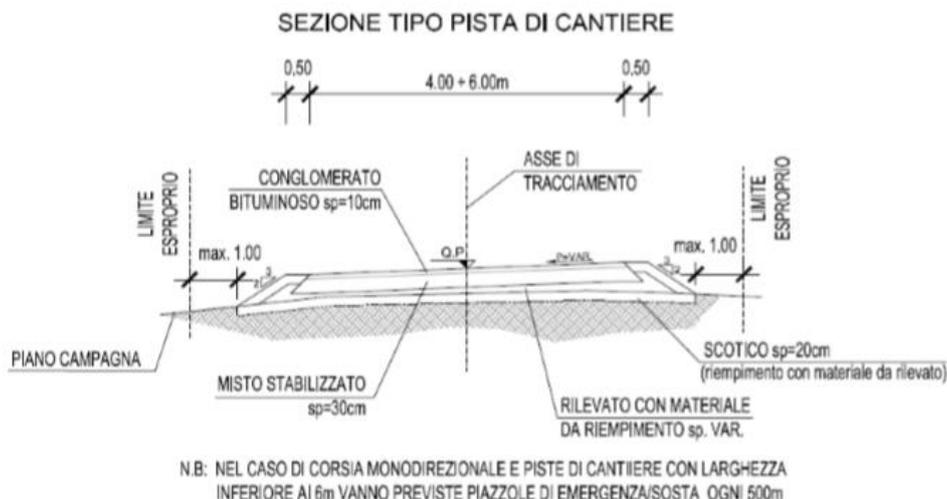
Figura 19: Sezione tipo Pista di cantiere
