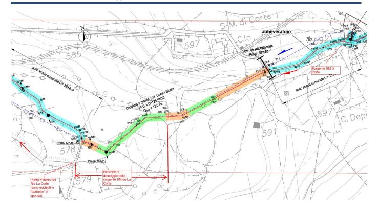
Comunque la tubazione di De 125 mm in questo tratto corre interrata con copertura minima di 1 m e quindi, ai sensi dell'art. 27 c.3 lett. g della N.A. del PAI,l'intervento ricade nella casistica per la quale non sono necessari studi di compatibilità idraulica.
