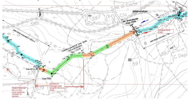
Comunque la tubazione di De 125 mm in questo tratto corre interrata con copertura minima di 1 m e quindi, ai sensi dell'art. 27 c.3 lett. g della N.A. del PAI, l'intervento ricade nella casistica per la quale non sono necessari studi di compatibilità idraulica
