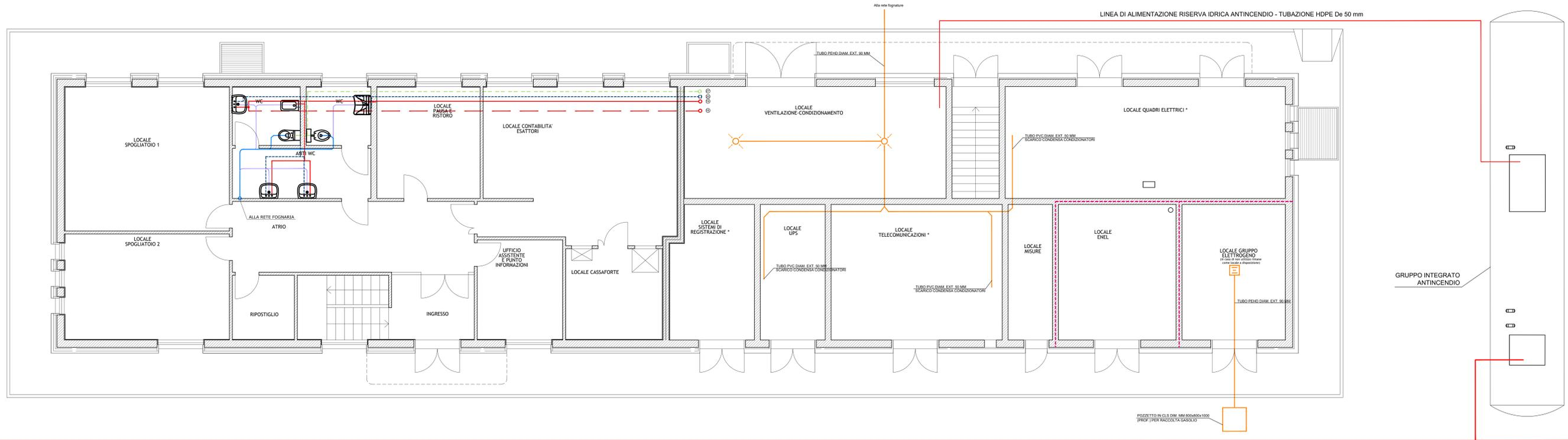
LINEA DI ALIMENTAZIONE RISERVA IDRICA ANTINCENDIO - TUBAZIONE HDPE De 50 mm
