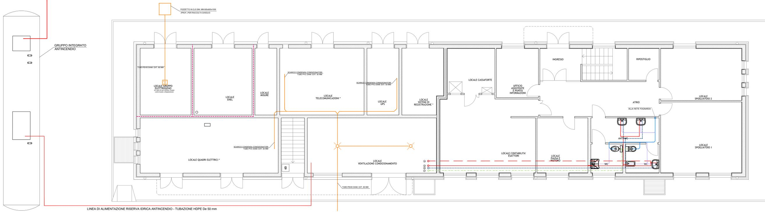
LINEA DI ALIMENTAZIONE RISERVA IDRICA ANTINCENDIO - TUBAZIONE HDPE De 50 mm
