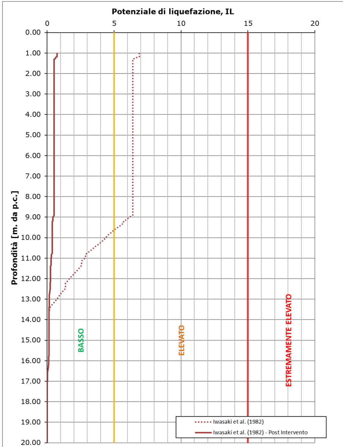
**FIGURA 5-3: CONFRONTO SUL POTENZIALE DI LIQUEFAZIONE PRE- E POST- INTERVENTO**
