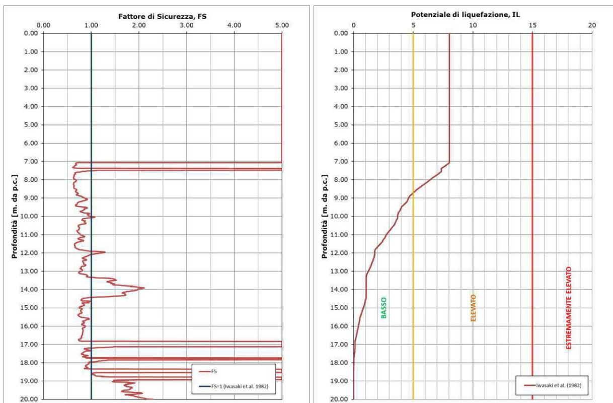
**FIGURA 3-1: OUTPUT DI CALCOLO DEL POTENZIALE DI LIQUEFAZIONE**
