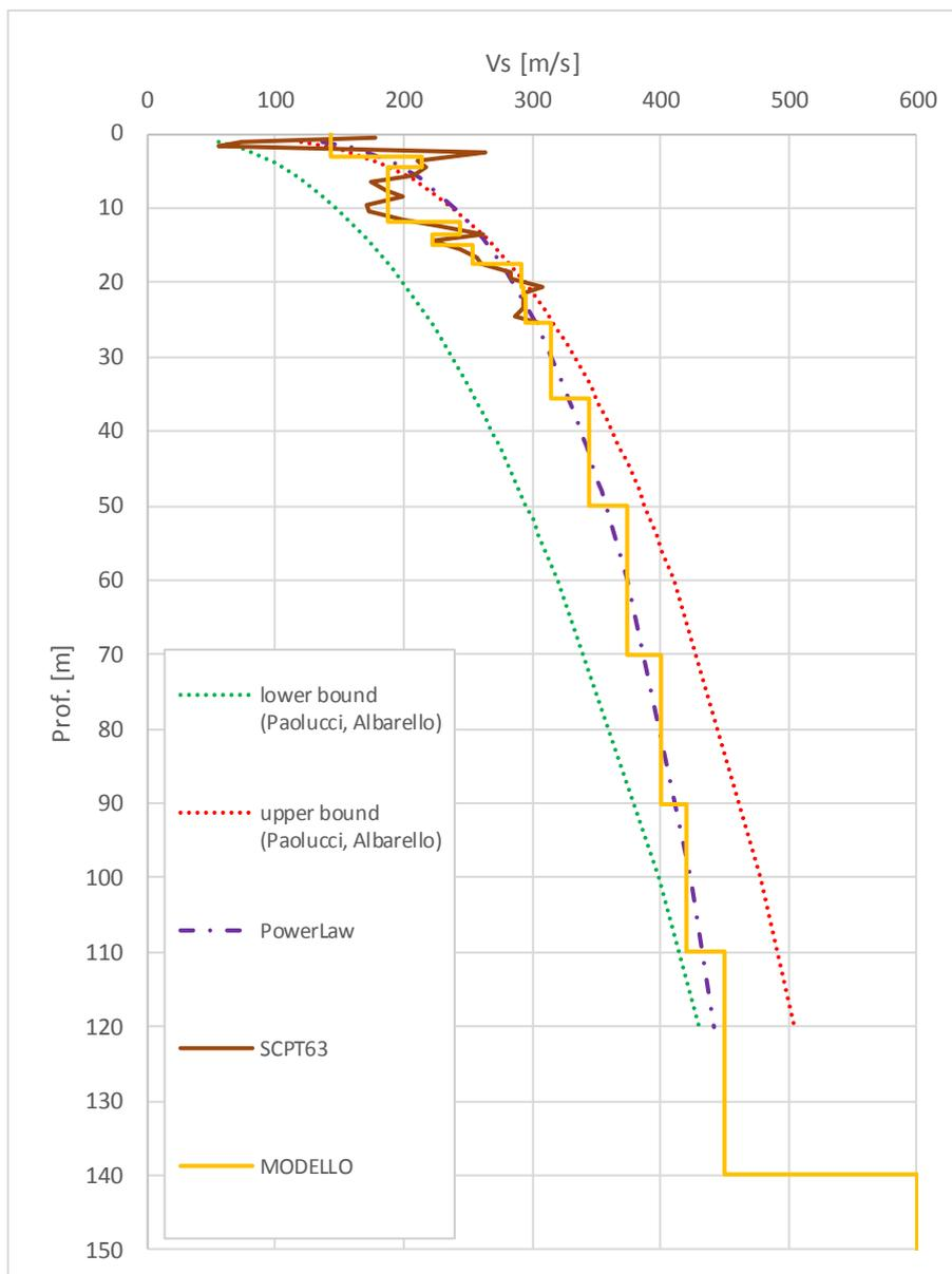
FIGURA 4-1 - PROFILO DI VS LUNGO LA VERTICALE DI INDAGINE SCPTU 63.
