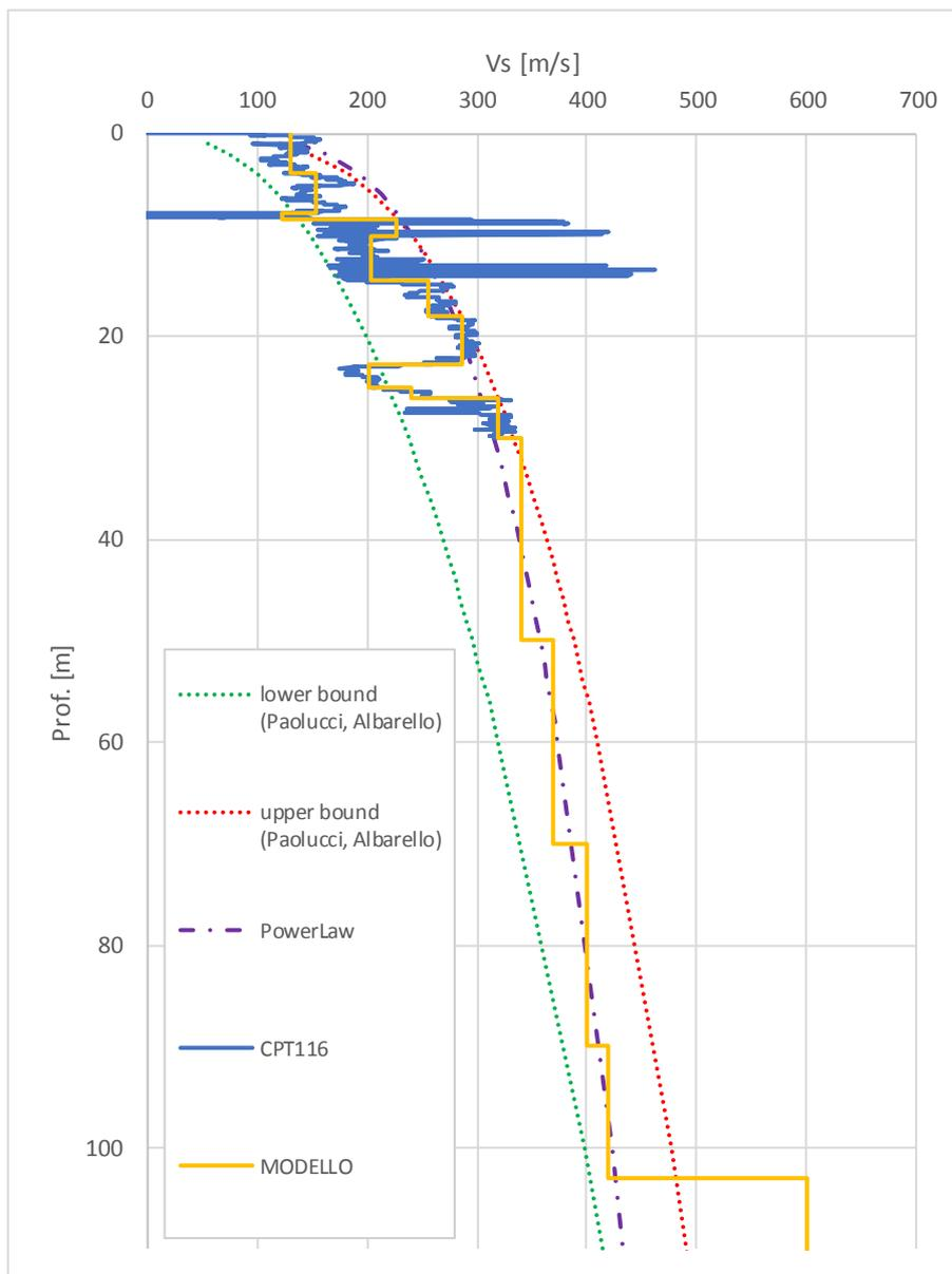
FIGURA 4-1 - PROFILO DI Vs LUNGO LA VERTICALE DI INDAGINE CPTU 116.
