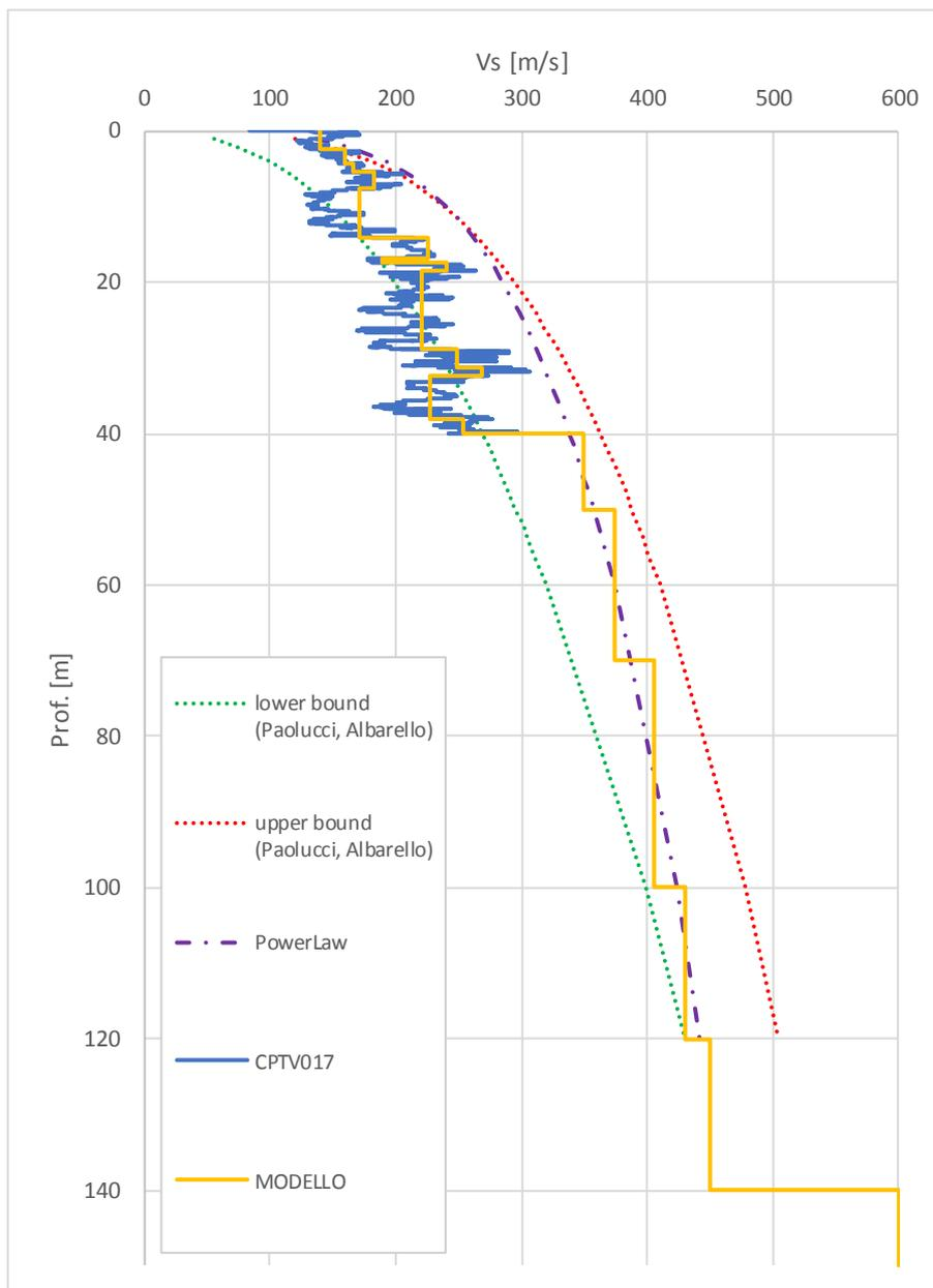
FIGURA 4-1 - PROFILO DI Vs LUNGO LA VERTICALE DI INDAGINE CPTU V017.
