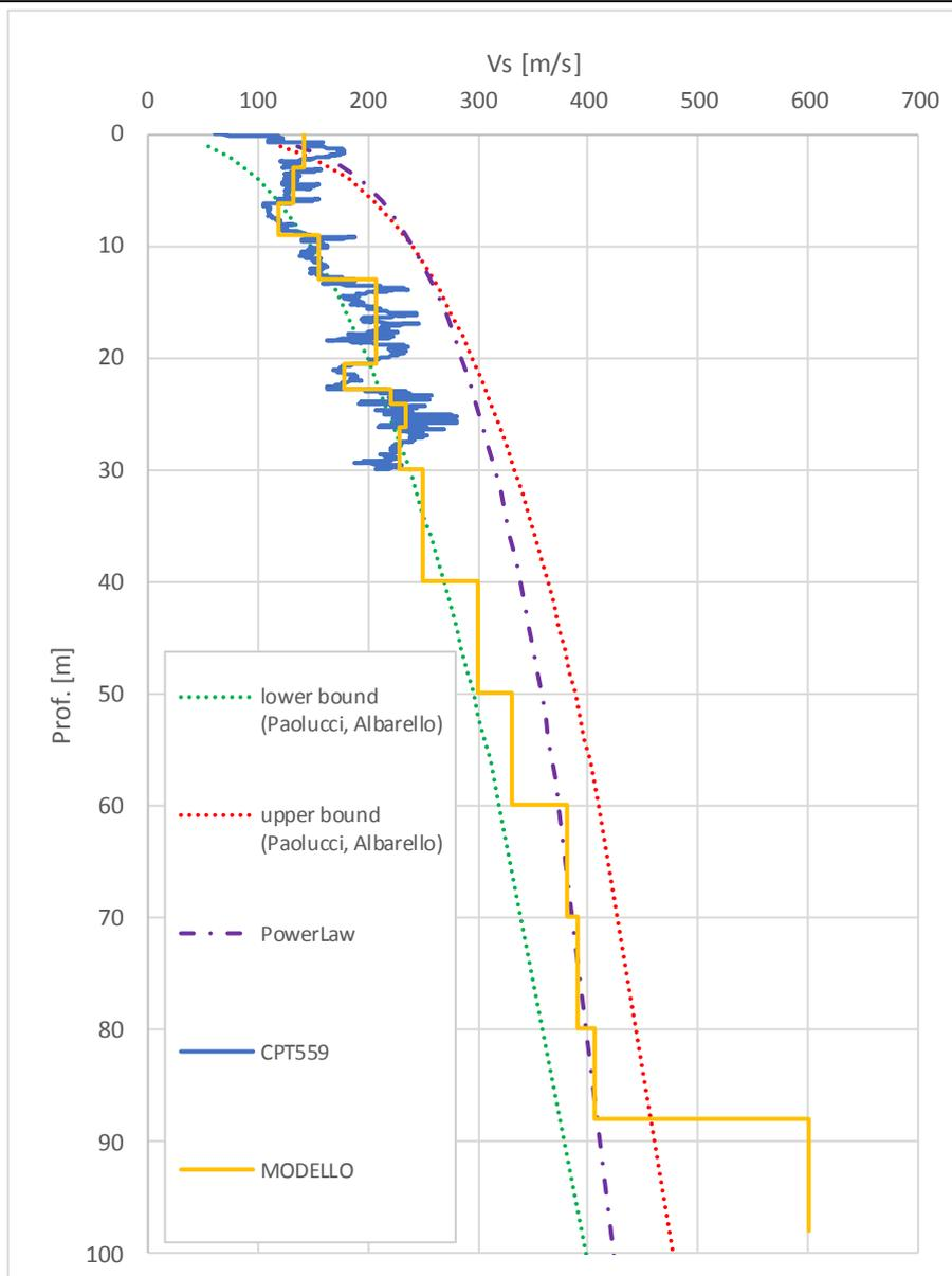
FIGURA 4-1 - PROFILO DI Vs LUNGO LA VERTICALE DI INDAGINE CPTU 559.
