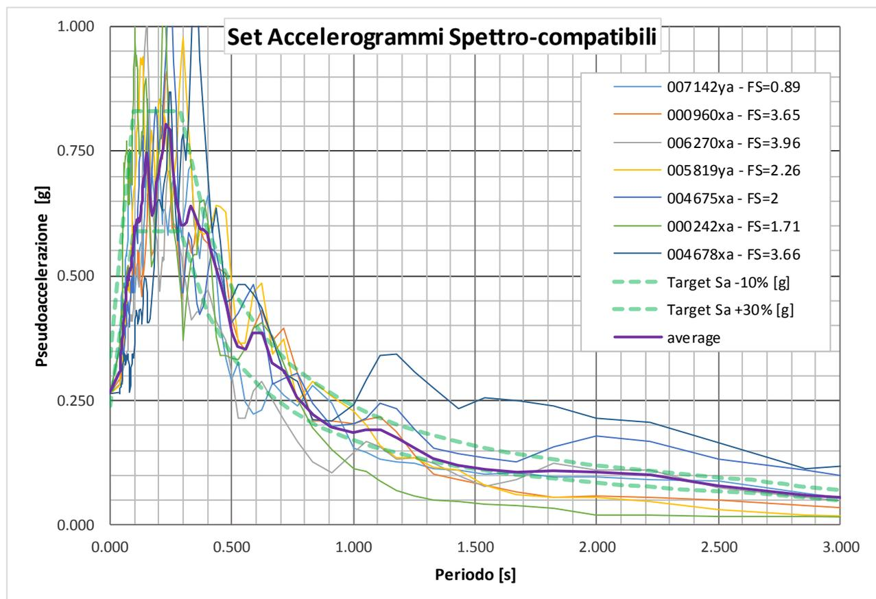
FIGURA 6-1 - SPETTRI TARGET PER LA RICERCA, SPETTRI DEI SINGOLI SEGNALI E RELATIVO SPETTRO MEDIO.
