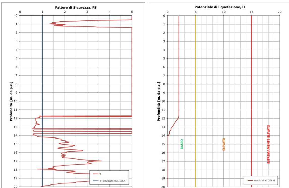
**FIGURA 3-8: OUTPUT DI CALCOLO DEL POTENZIALE DI LIQUEFAZIONE PER LA 1FE-CPTU 030 CON ACCELERAZIONE DA APPROCCIO SEMPLIFICATO**
