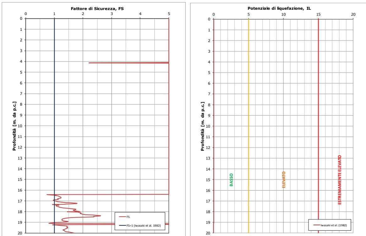
**FIGURA 3-1: OUTPUT DI CALCOLO DEL POTENZIALE DI LIQUEFAZIONE PER LA 1FE-CPTU 023 CON ACCELERAZIONE DA APPROCCIO SEMPLIFICATO**
