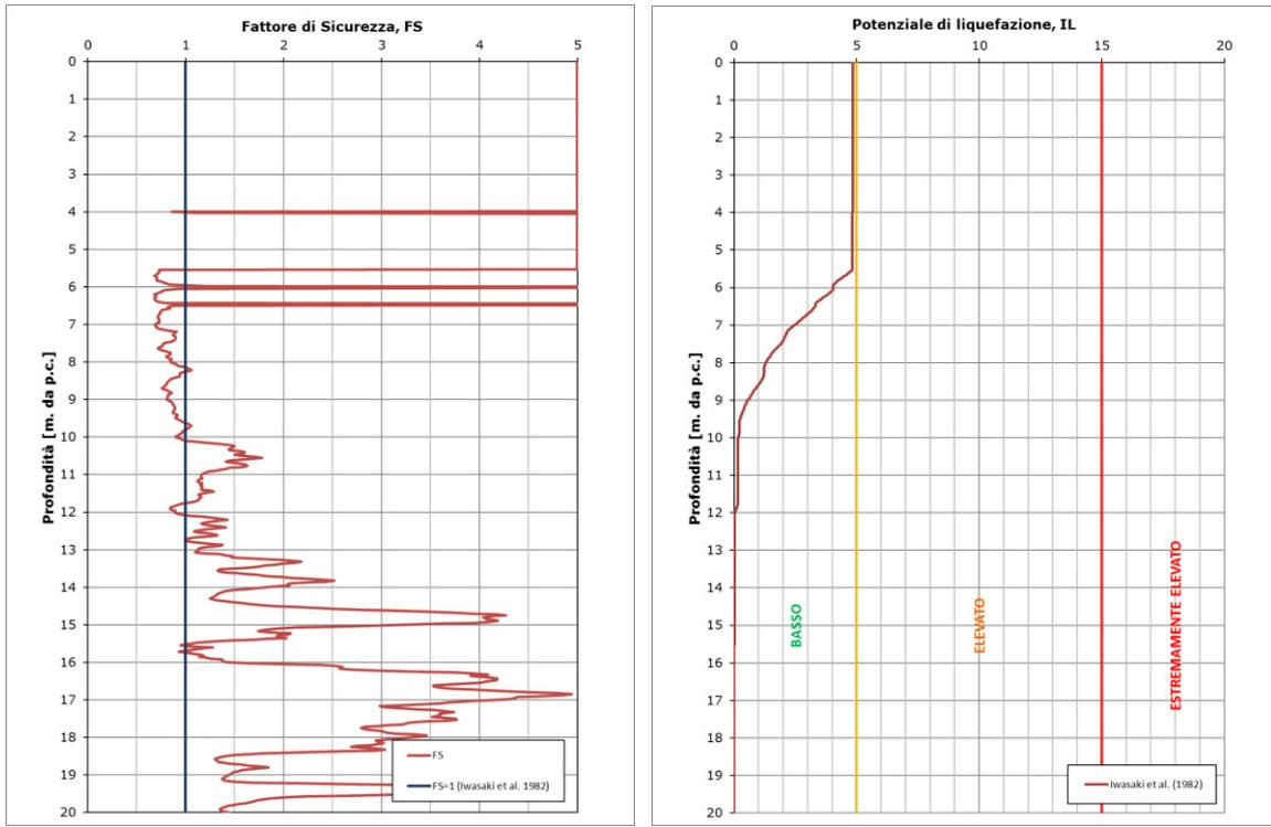
**FIGURA 3-11: OUTPUT DI CALCOLO DEL POTENZIALE DI LIQUEFAZIONE PER LA 1FE-CPTU 032A CON ACCELERAZIONE DA APPROCCIO SEMPLIFICATO**
