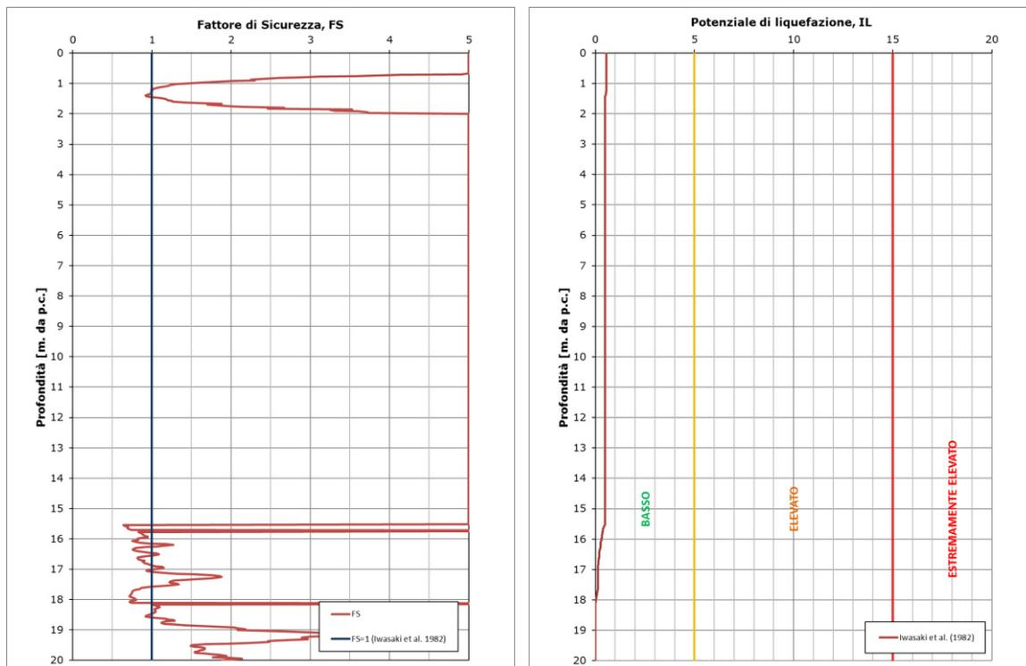
**FIGURA 3-2: OUTPUT DI CALCOLO DEL POTENZIALE DI LIQUEFAZIONE PER LA 1FE-CPTU 024 CON ACCELERAZIONE DA APPROCCIO SEMPLIFICATO**
