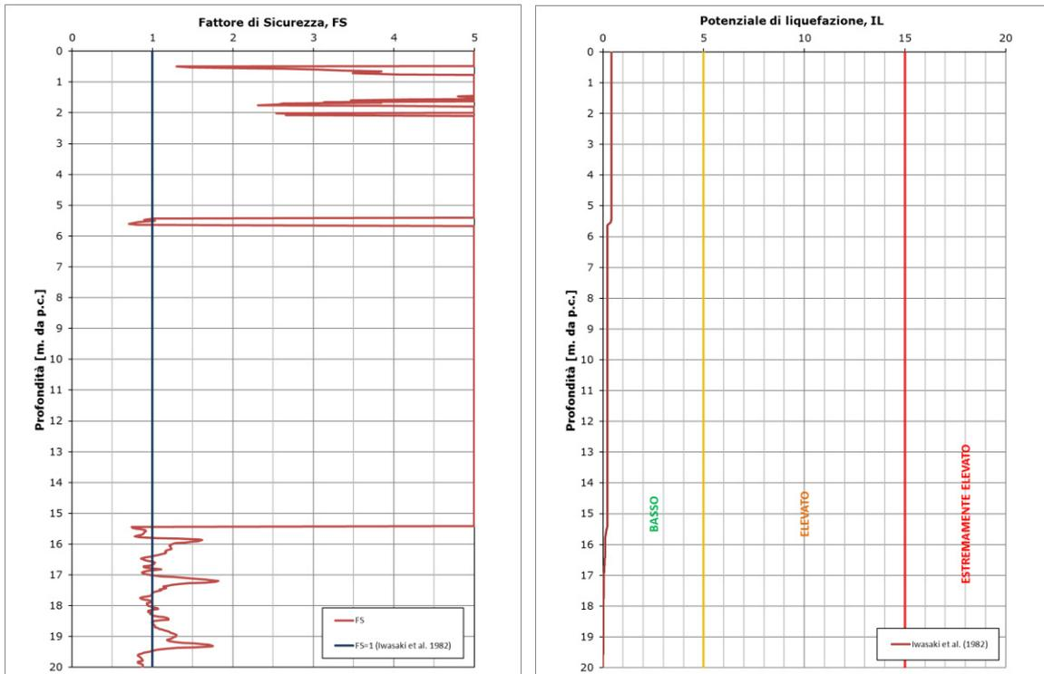
FIGURA 3-4: OUTPUT DI CALCOLO DEL POTENZIALE DI LIQUEFAZIONE PER LA 1FE-CPTU 026 CON ACCELERAZIONE DA APPROCCIO SEMPLIFICATO
