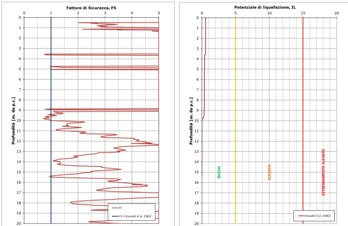
**FIGURA 3-5: OUTPUT DI CALCOLO DEL POTENZIALE DI LIQUEFAZIONE PER LA 1FE-CPTU 027 CON ACCELERAZIONE DA APPROCCIO SEMPLIFICATO**
