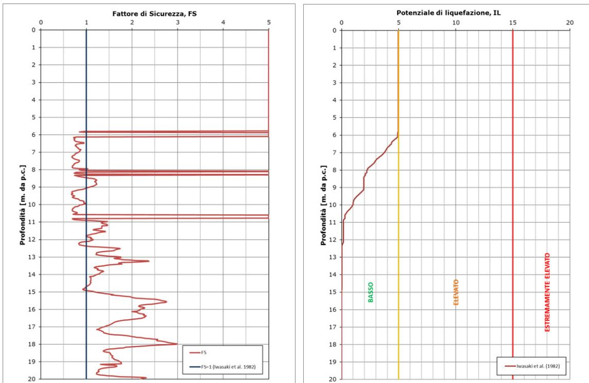
**FIGURA 3-6: OUTPUT DI CALCOLO DEL POTENZIALE DI LIQUEFAZIONE PER LA 1FE-CPTU 028 CON ACCELERAZIONE DA APPROCCIO SEMPLIFICATO**
