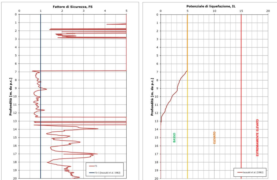
**FIGURA 3-7: OUTPUT DI CALCOLO DEL POTENZIALE DI LIQUEFAZIONE PER LA 1FE-CPTU 029 CON ACCELERAZIONE DA APPROCCIO SEMPLIFICATO**
