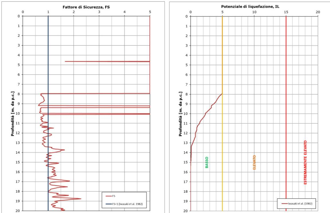
**FIGURA 3-12: OUTPUT DI CALCOLO DEL POTENZIALE DI LIQUEFAZIONE PER LA 1FE-CPTU 033 CON ACCELERAZIONE DA APPROCCIO SEMPLIFICATO**
