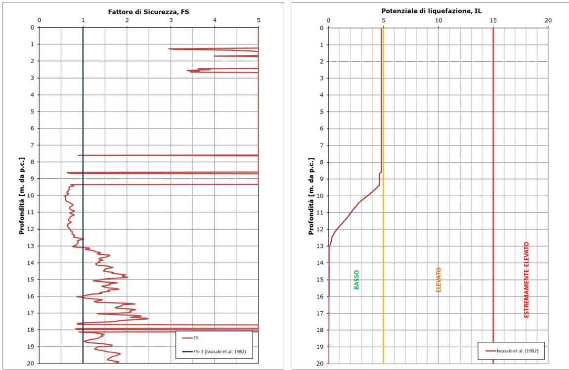
**FIGURA 3-9: OUTPUT DI CALCOLO DEL POTENZIALE DI LIQUEFAZIONE PER LA 1FE-CPTU 031 CON ACCELERAZIONE DA APPROCCIO SEMPLIFICATO**
