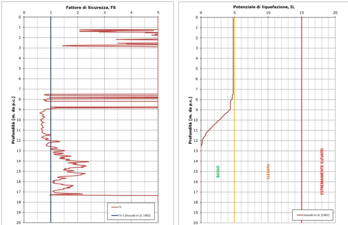
**FIGURA 3-10: OUTPUT DI CALCOLO DEL POTENZIALE DI LIQUEFAZIONE PER LA 1FE-CPTU 032 CON ACCELERAZIONE DA APPROCCIO SEMPLIFICATO**
