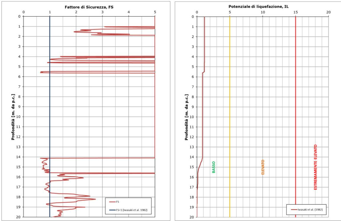
FIGURA 3-3: OUTPUT DI CALCOLO DEL POTENZIALE DI LIQUEFAZIONE PER LA 1FE-CPTU 025 CON ACCELERAZIONE DA APPROCCIO SEMPLIFICATO
