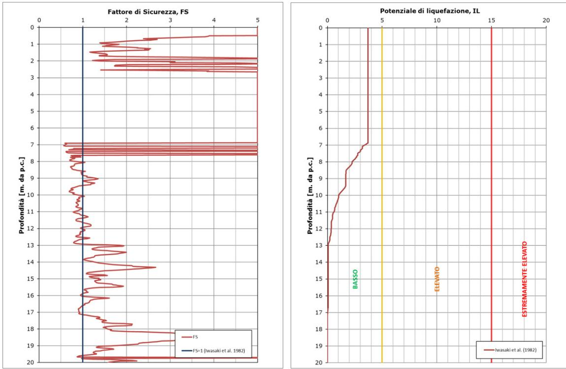
**FIGURA 3-13: OUTPUT DI CALCOLO DEL POTENZIALE DI LIQUEFAZIONE PER LA 1FE-CPTU 034 CON ACCELERAZIONE DA APPROCCIO SEMPLIFICATO**
