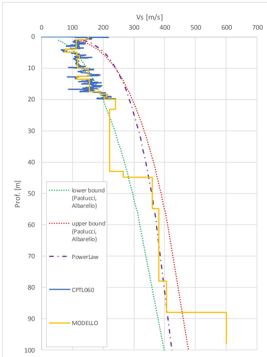
FIGURA 4-1 - PROFILO DI Vs LUNGO LA VERTICALE DI INDAGINE CPTUL 60.
