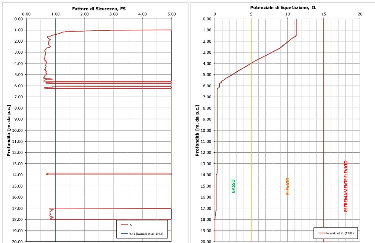
FIGURA 3-1: OUTPUT DI CALCOLO DEL POTENZIALE DI LIQUEFAZIONE
