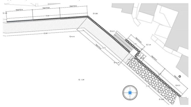
I pali da realizzare vanno dal più piccolo di diametro pari a 200mm (micropalo) al più grande di diametro pari a 600mm.
