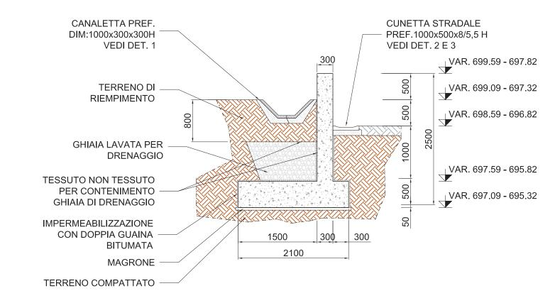
MURO 11 - SEZIONE A SCALA 1:50
