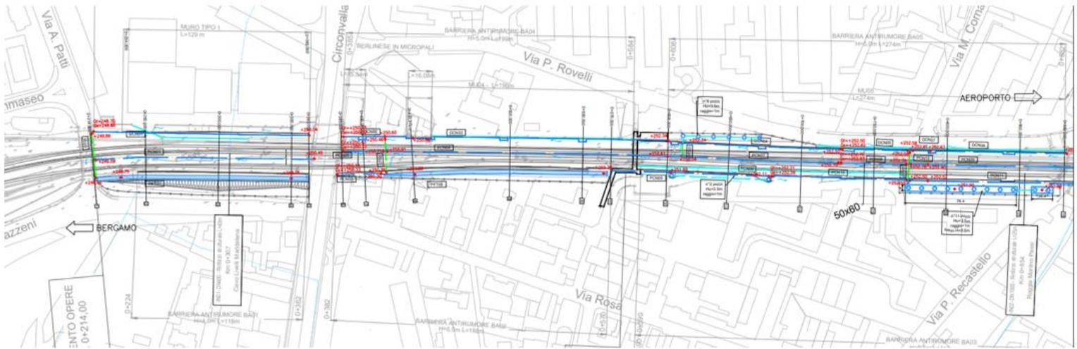
barriere fonoassorbenti di progetto per una lunghezza di 600 ml alte 6.50 mt posizionamento di 19 pozzi perdenti di diametro 2 mt con altezza fuori terra di 3.50 mt
