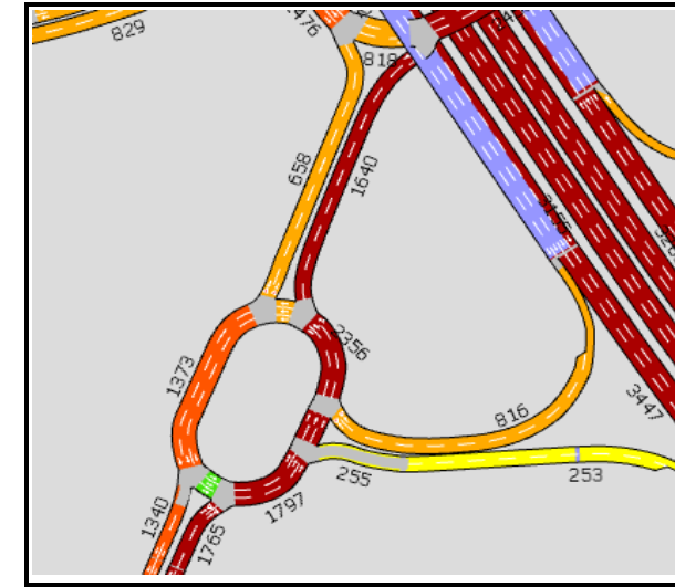
Flussi in ingresso e uscita al nodo (veicoli totali)
