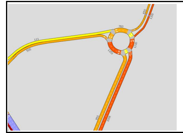
Flussi in ingresso e uscita al nodo (veicoli totali)
