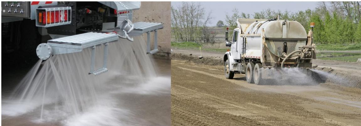
**Figura 2-71: Automezzo per la bagnatura delle piste sterrate**
