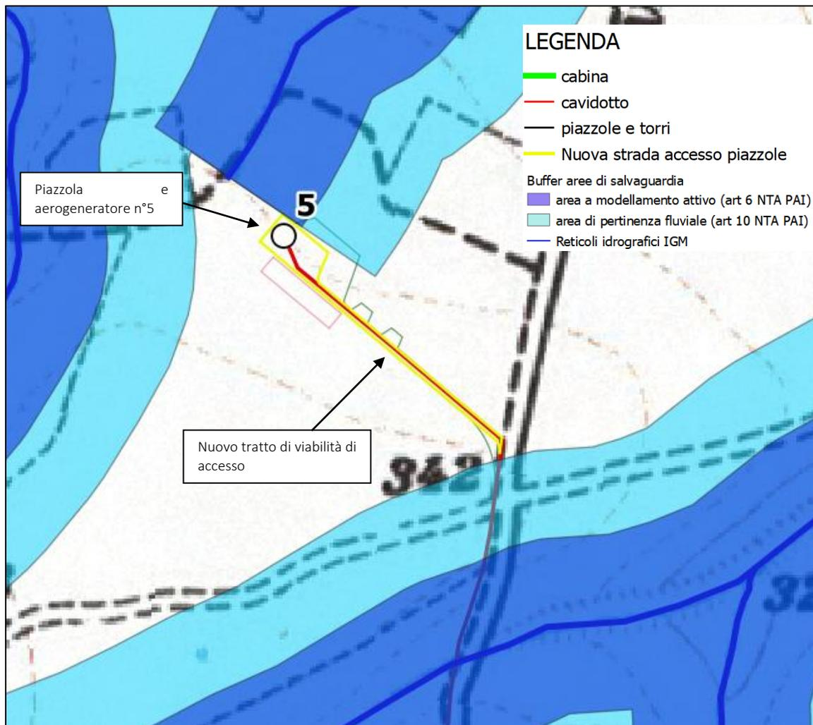
**[WTG 5]** Particolare della posizione dell'aerogeneratore, della piazzola e della nuova viabilità di accesso su stralcio cartografico IGM 1:25.000 rispetto alle fasce di salvaguardia di cui agli artt 6 e 10 delle NTA del PAI: in rosso i cavidotti di collegamento, in giallo i nuovi tratti di viabilità, in blu i reticoli idrografici.
