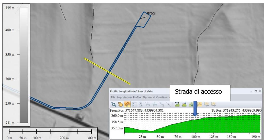
Profilo trasversale del DTM in prossimità della strada di accesso alla torre WTG 04 e il reticolo idrografico.
