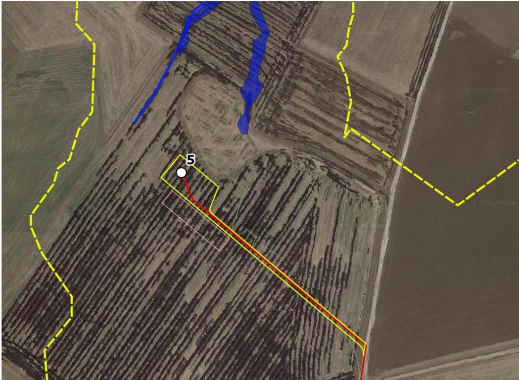
Verifica compatibilità torre WTG 5, strada di accesso in giallo e i cavidotti in rosso. In blu le aree a media pericolosità idraulica
