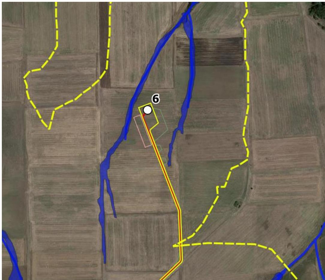
*Verifica compatibilità torre WTG 6, strada di accesso in giallo e i cavidotti in rosso. In blu le aree a media pericolosità idraulica*
