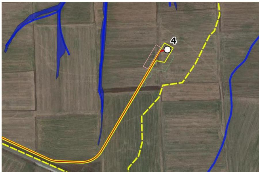
Verifica compatibilità torre WTG 4, strada di accesso in giallo e i cavidotti in rosso. In blu le aree a media pericolosità idraulica
