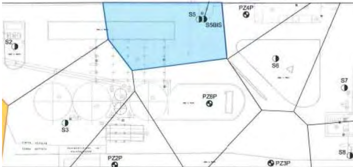
Fig. 4.2 - Superamenti terreni – Sorgente S5bis ARPAV – Terreno saturo (per cui non presente in AdR)
