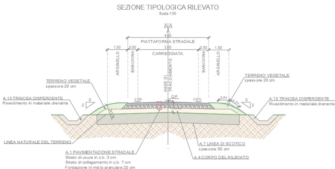
Figura 1: Sezione tipologica
