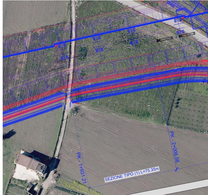
Variante 1 – Tratto di rilevato in allargamento in corrispondenza degli scambi (Sezione tipo 1) - Inquadramento su ortofoto – In rosso il progetto esecutivo, in blu il Progetto esecutivo di variante
