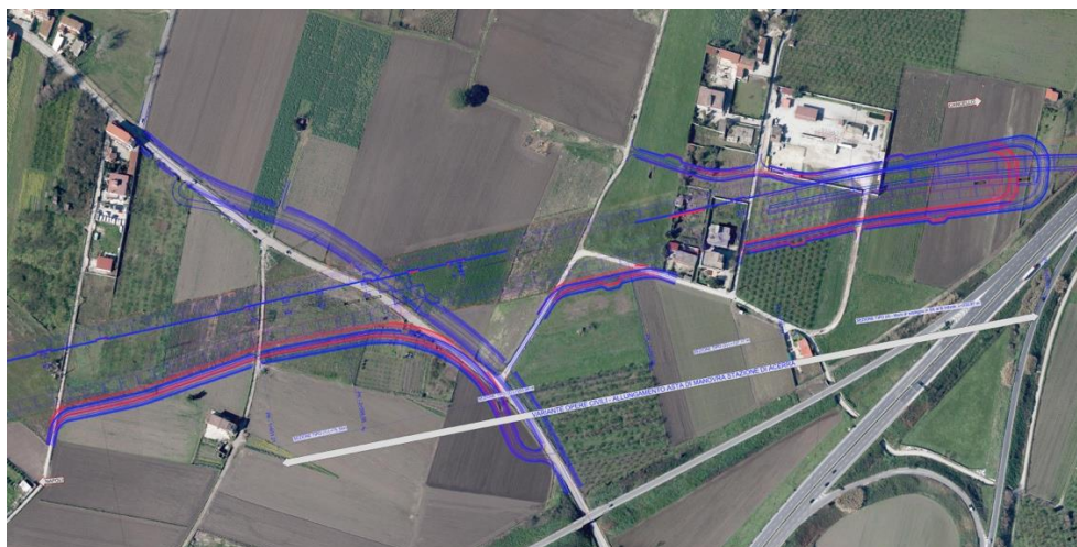
Variante 1 – Tratto 2 - Inquadramento su ortofoto – In rosso la posizione delle opere prima della variante
