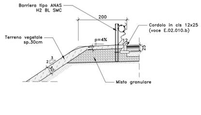
DETTAGLIO MARGINE IN RILEVATO (2)
