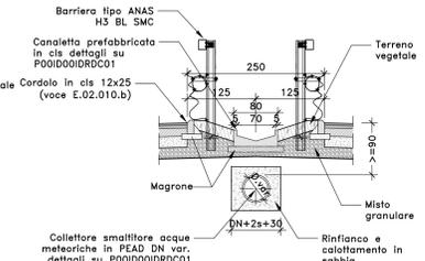
DETTAGLIO MARGINE IN RILEVATO (1)
