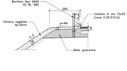
DETTAGLIO MARGINE IN RILEVATO (2)
