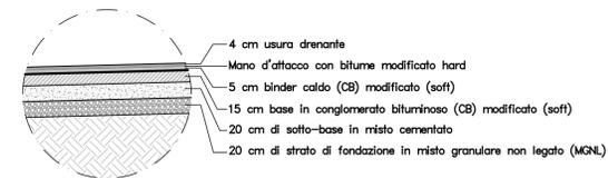
SEZIONE TIPO RAMPA DI SVINCOLO BIDIREZIONALE
