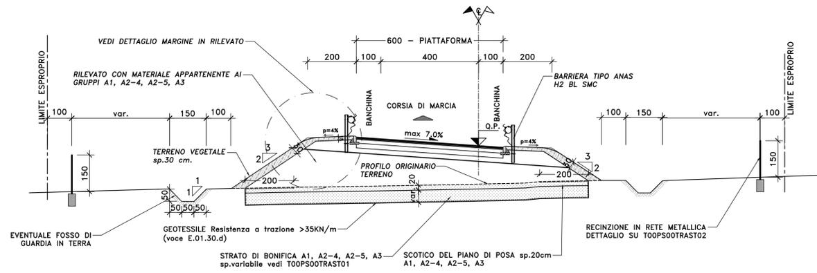
DETTAGLIO MARGINE IN RILEVATO
