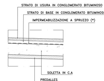
(\*) Impermeabilizzazione a spruzzo eseguita con prodotto elastomero polietanico bicomponente. Il rivestimento dovrà essere continuo e perfettamente impermeabile all'acqua, ma permeabile ai gas ed ai vapori acq. Spessore finito non inferiore a 3 mm.
