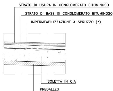
(\*) Impermeabilizzazione a spruzzo eseguita con prodotto elastomerico poliuretano bicomponente. Il rivestimento dovrà essere continuo e perfettamente impermeabile all'acqua, ma permeabile ai gas ed ai vapori acq. Spessore finito non inferiore a 3 mm.
