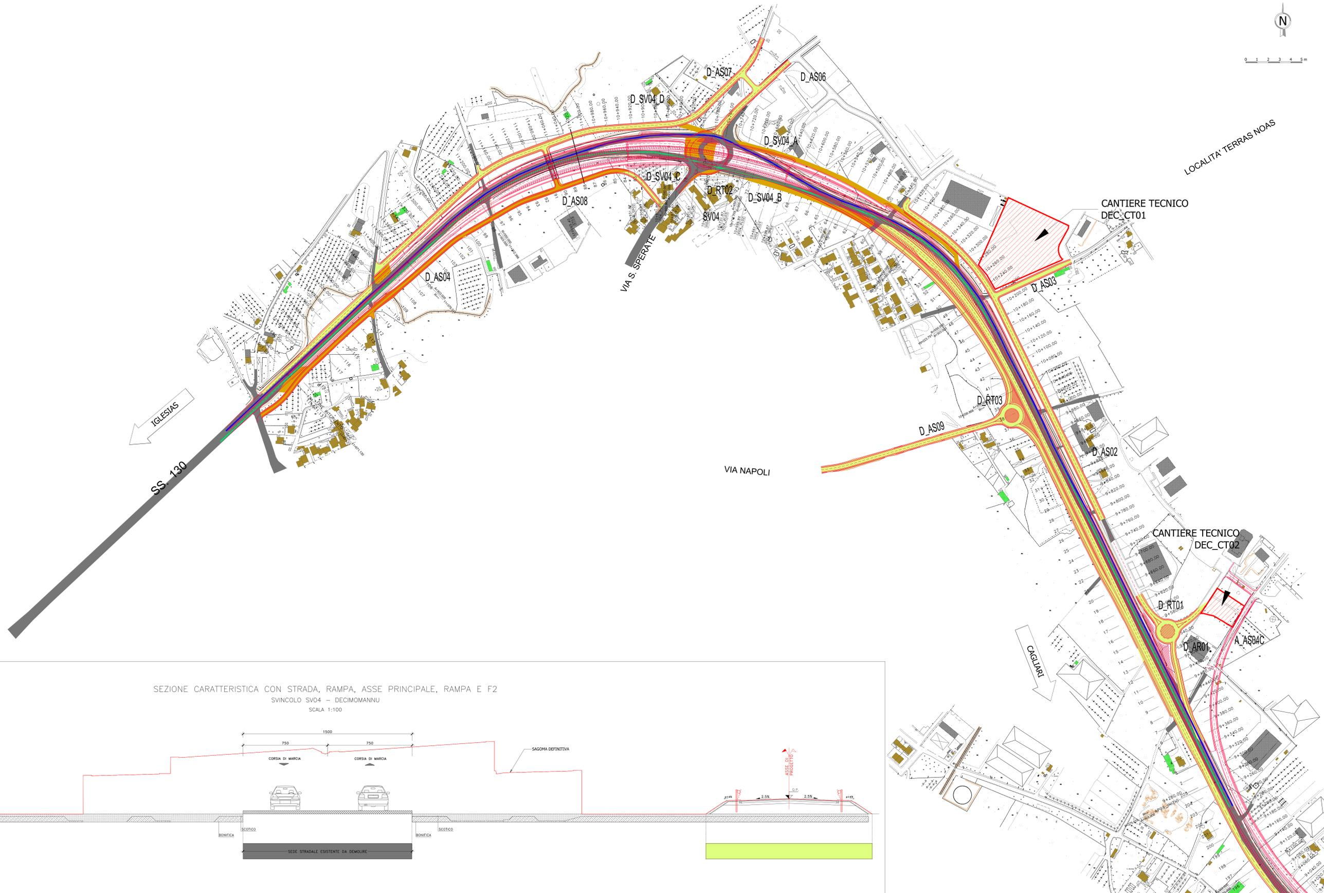
SEZIONE CARATTERISTICA CON STRADA, RAMPA, ASSE PRINCIPALE, RAMPA E F2
