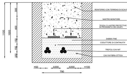
SEZIONE ATTRAVERSAMENTO "3C" TRE LINEE
