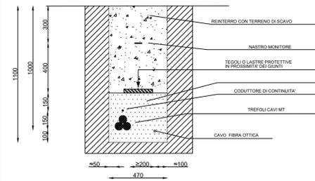
SEZIONE ATTRAVERSAMENTO "2C" DUE LINEE
