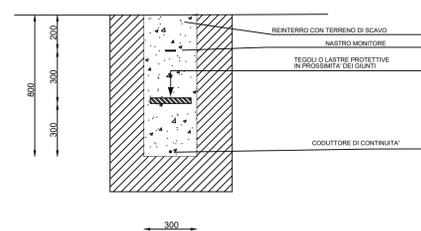
SEZIONE ATTRAVERSAMENTO "MM" MET MAST
