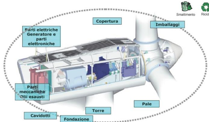
**Figura 5: Elementi riciclabili e smaltibili di una turbina eolica**
