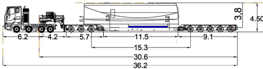
SG 170 - Nacelle - (98.00 Ton. x 14.614 x 4.72 x 3.405)
