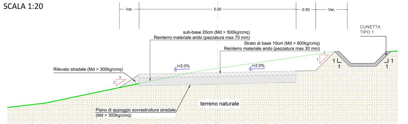
SEZIONE TIPICA VIABILITÀ DA REALIZZARE IN RILEVATO
