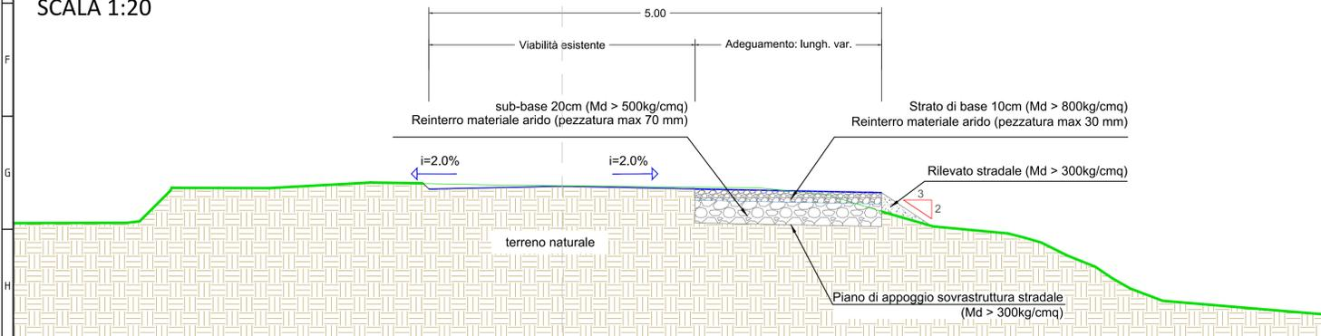
SEZIONE TIPICA VIABILITÀ ESISTENTE CON ADEGUAMENTO SUL LATO SINISTRO E DESTRO
