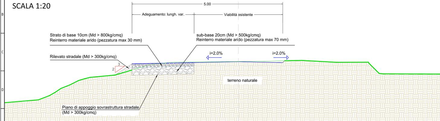
SEZIONE TIPICA VIABILITÀ ESISTENTE CON ADEGUAMENTO SUL LATO DESTRO
