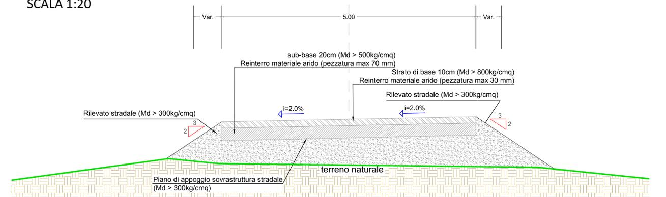
SEZIONE TIPICA VIABILITÀ DA REALIZZARE IN SCAVO
