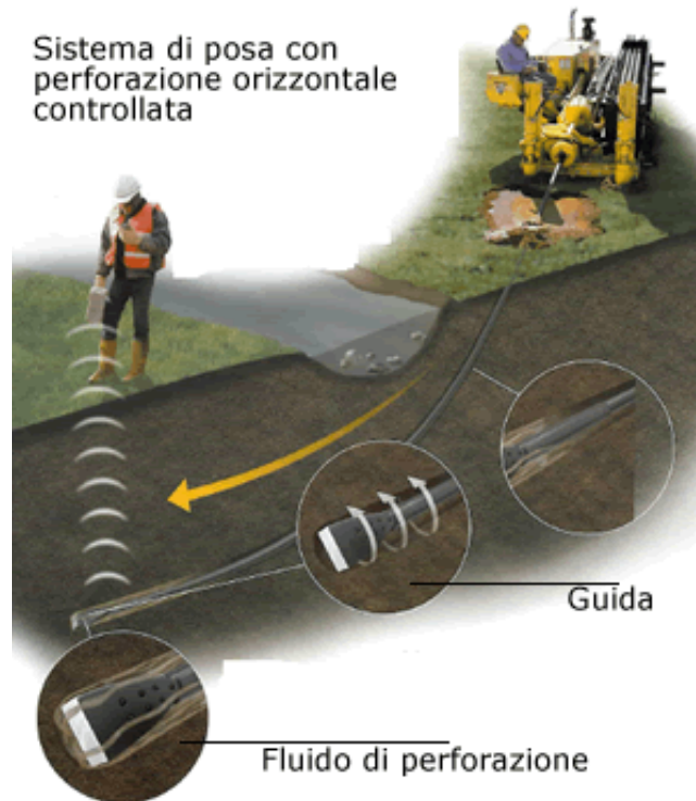
Figura 10 – Sistema di trivellazione orizzontale controllata (T.O.C.).
