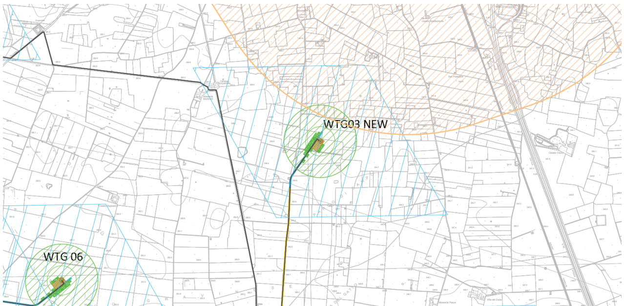
Figura 6 - Particolare buffer 1200 metri dai centri abitati e buffer 200 metri da ogni aerogeneratore
