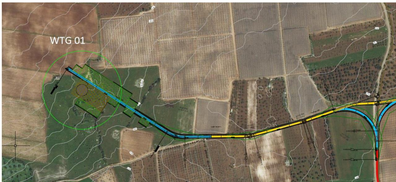
**Figura 79 Soluzione di progetto per la WTG01**
