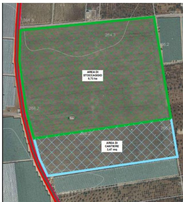
**Figura 26** In azzurro l'individuazione dell'area logistica di cantiere e in verde l'area di stoccaggio
