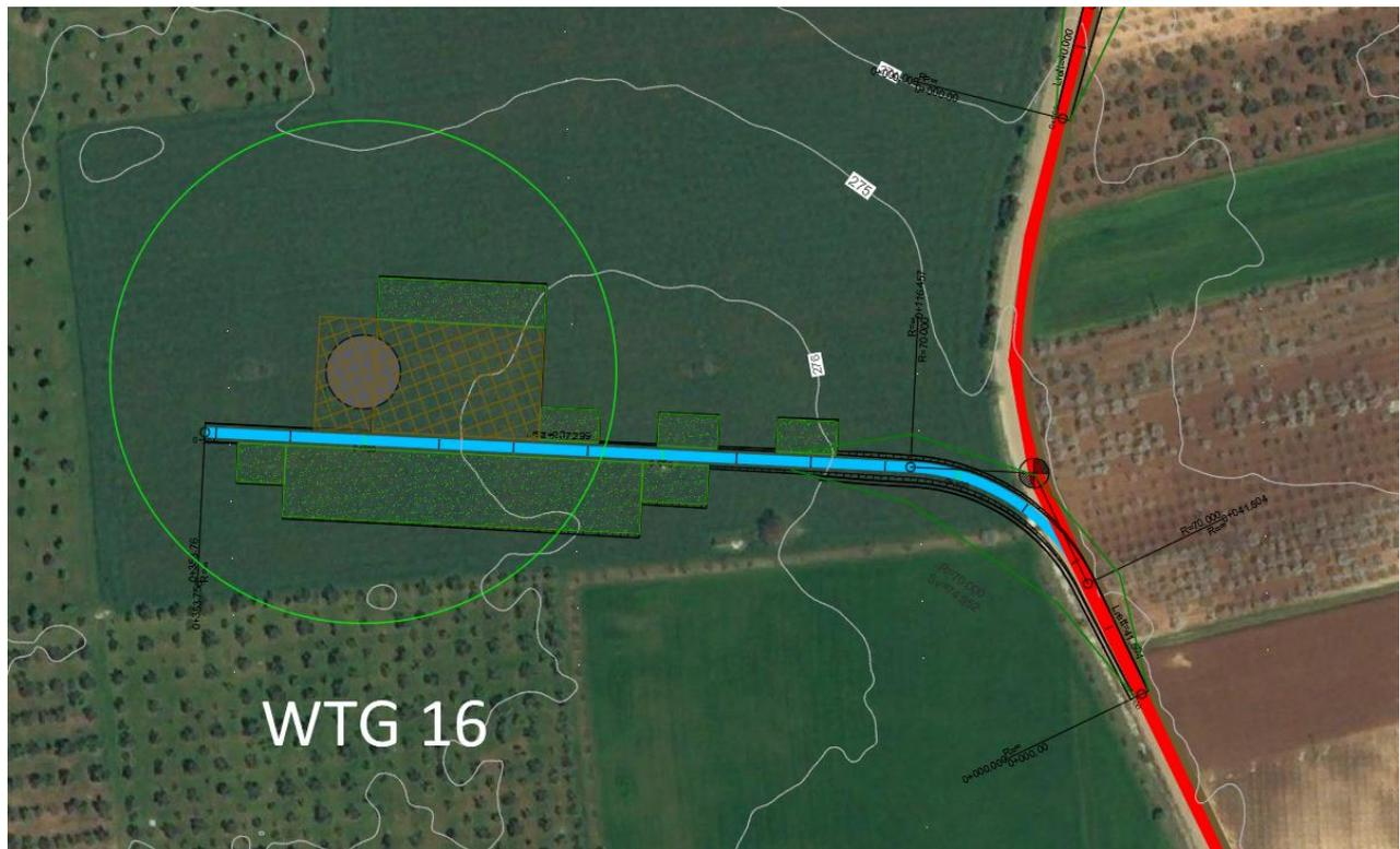
**Figura 52 Soluzione di viabilità per WTG16**
