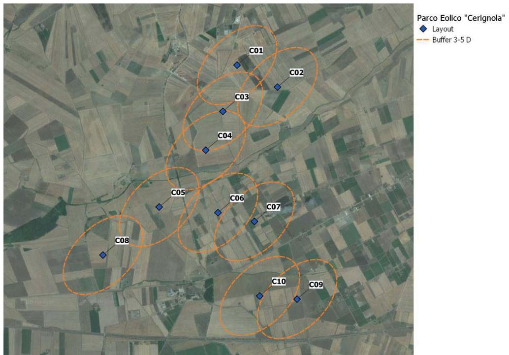
Figura 64: Layout di impianto con evidenza dei buffer ellittici pari a 3-5 diametri
