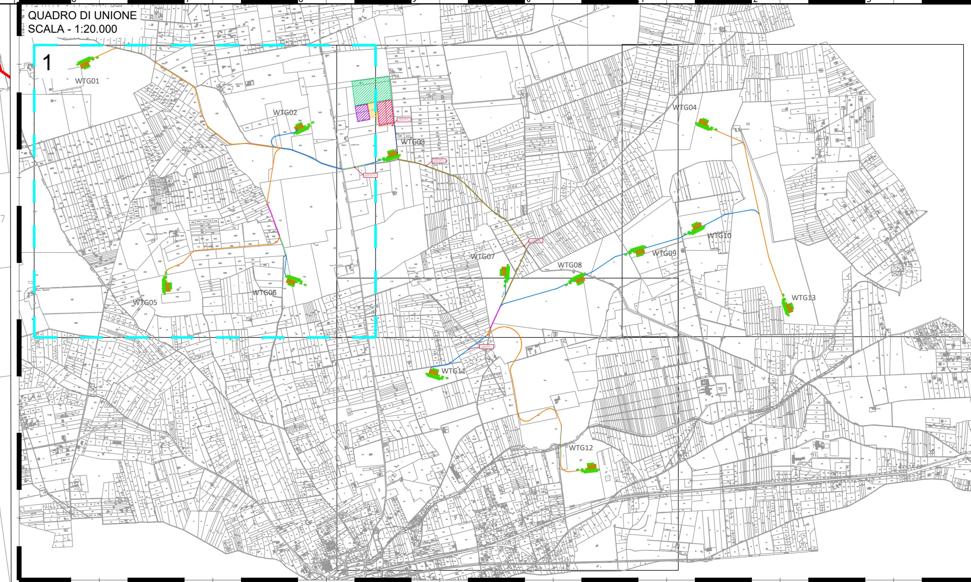
Schema di collegamento WTG e lunghezza del tracciato dei cavidotti MT
