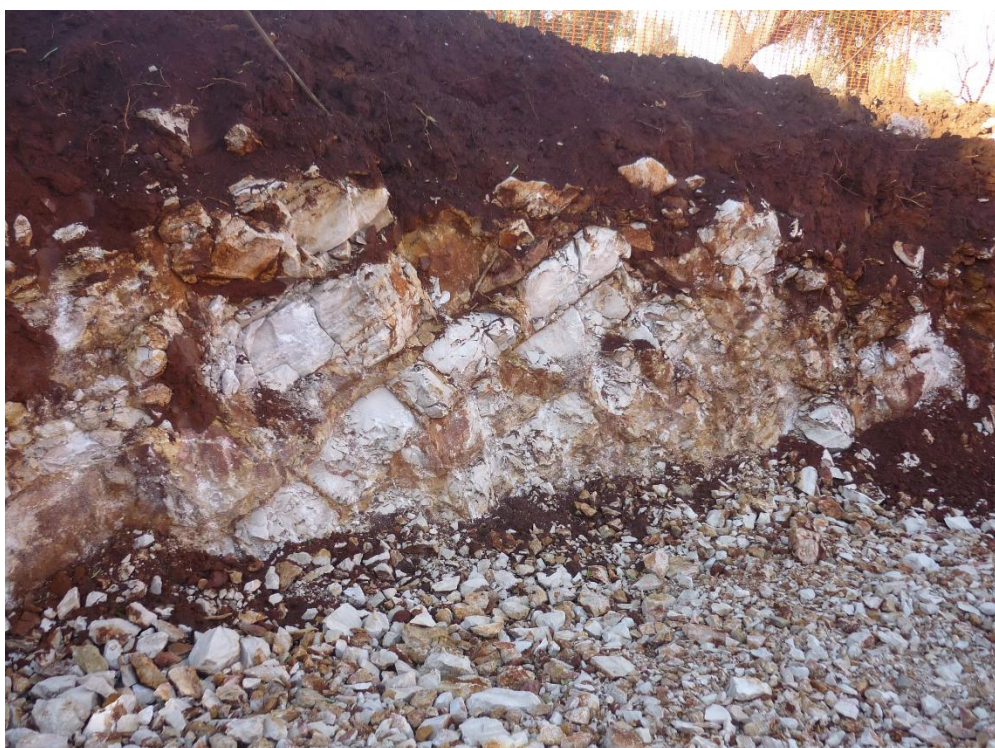
Figura 8: Calcere di Altamura (Affioramento in scavi di fondazione a nord dell'area in studio).
