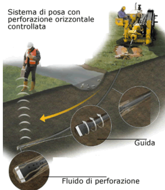
Figura 10 – Sistema di trivellazione orizzontale controllata (T.O.C.).
