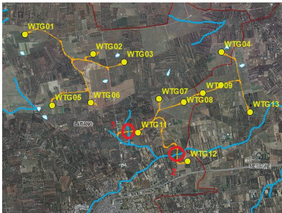
Figura 7 Inquadramento delle intersezioni del progetto con i reticoli idrografici sulla carta idrogeomorfologica della Regione Puglia redatta dell'AdB.
