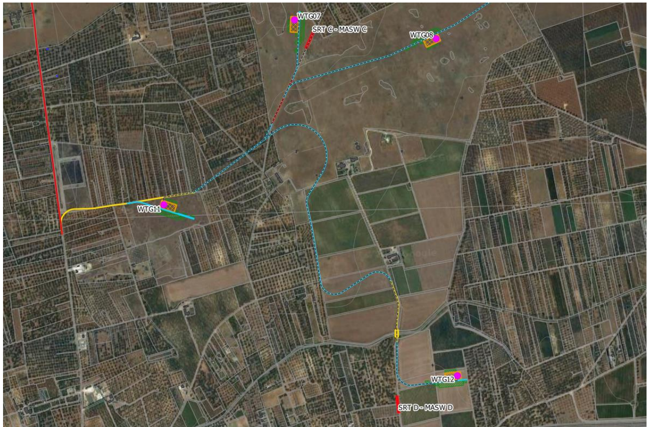
Figura 6: Ubicazione indagini geofisiche.
