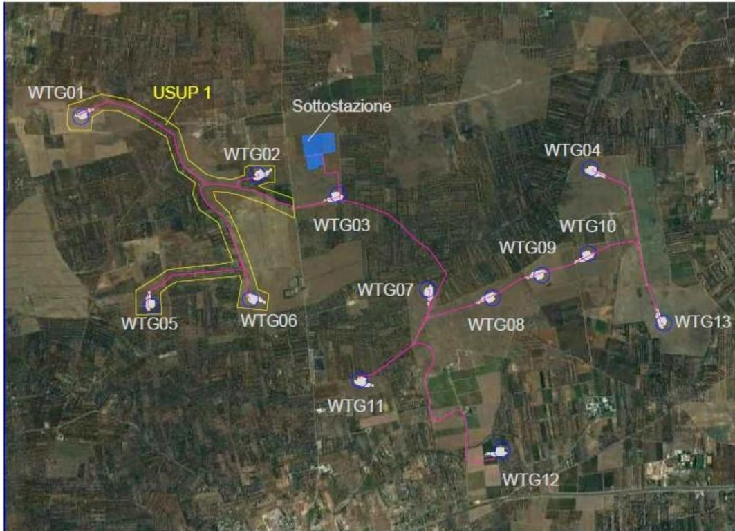
**Foto n. 1: immagine satellitare con i limiti dell'USUP 1 (in giallo) e del cavidotto (in fucsia)**
