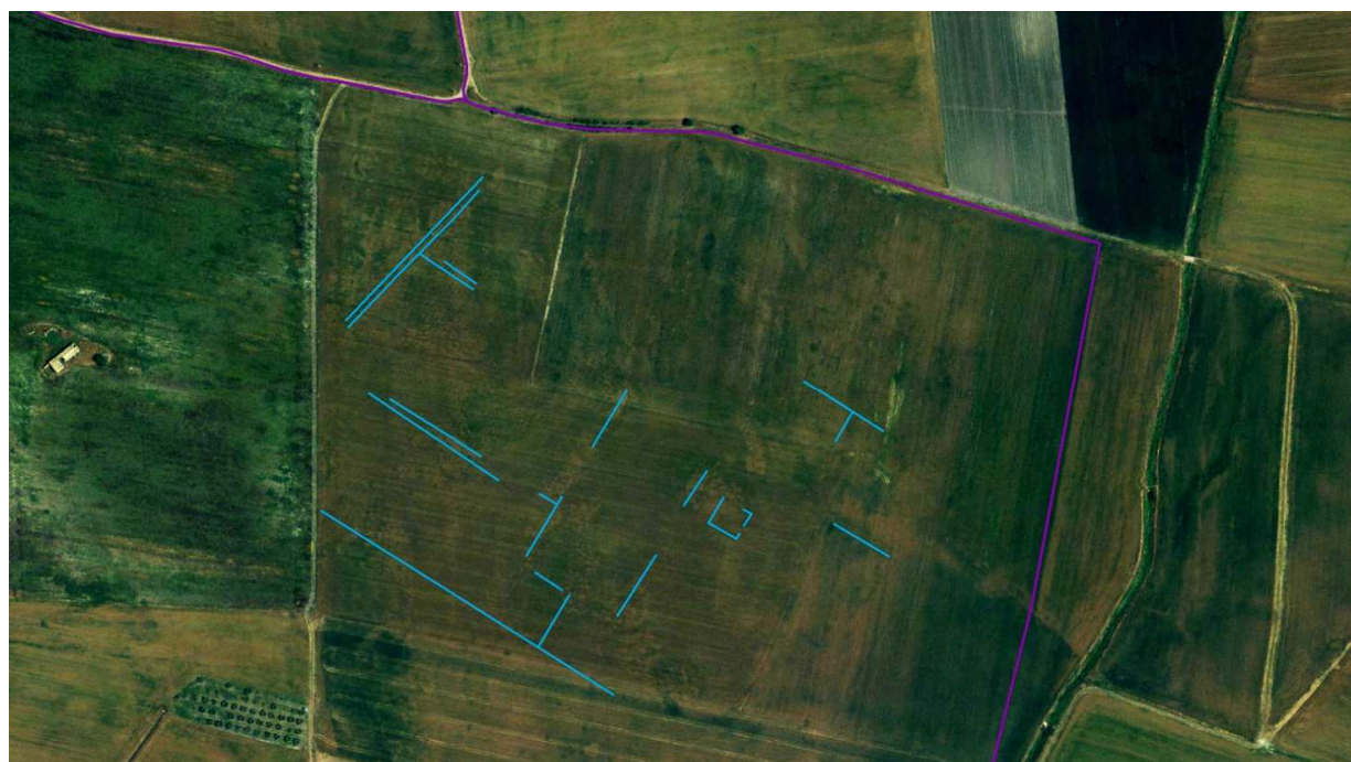
Figura 27: Localizzazione delle anomalie individuate (in azzurro) rispetto alle opere in progetto (in viola).
