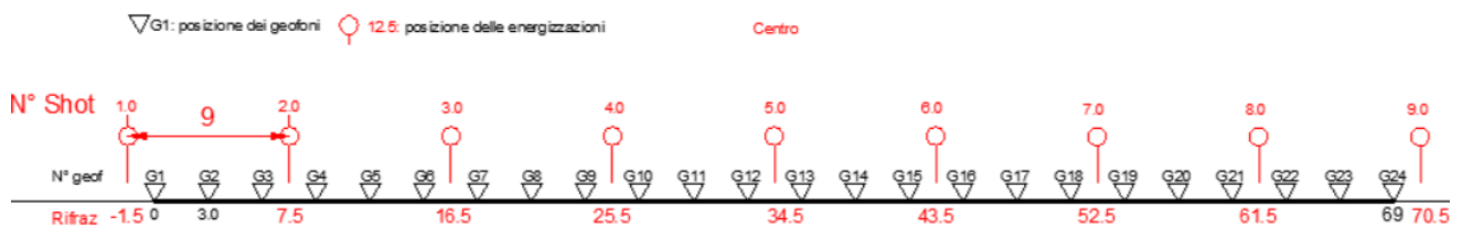
Figura 14. 3: Stendimento di sismica a rifrazione in onde P con 24 geofoni e interdistanza di 3,0 m
