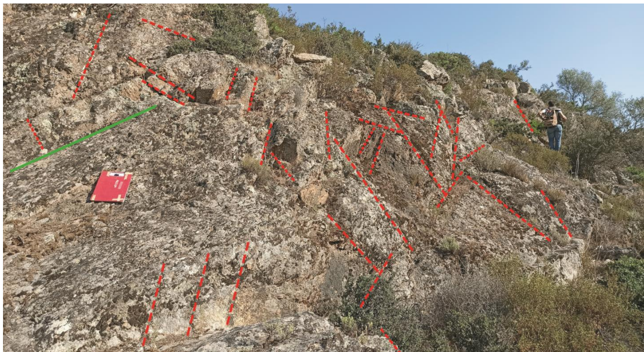
Figura 7. 6: Vista sull’affioramento dei Porfiroidi (PRFa-5) con le tracce della foliazione (in verde), e dei giunti di fratturazione (in rosso).
