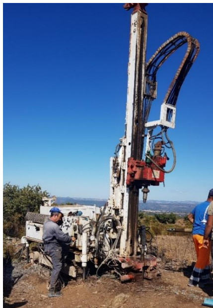
Figura 14. 2: a) Sonda BOART LONGYEAR SPA Mod. DELTABASE 520 e b) Sonda idraulica Hydra mod. Joy3
