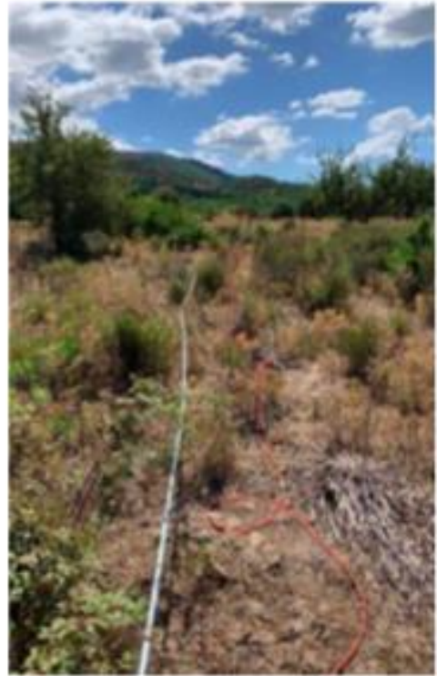
Stendimento M1 dal Geofono 24 al Geofono 1
