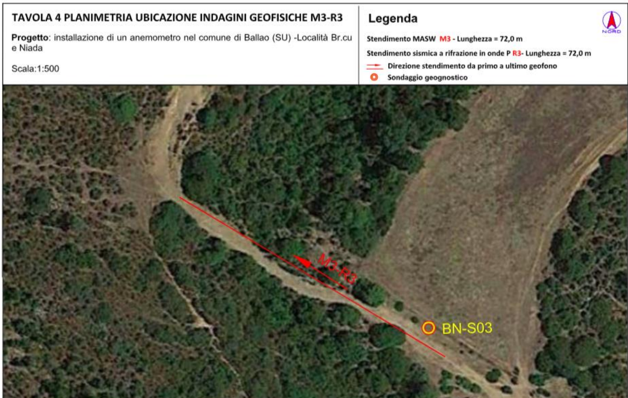
Figura 6.5: Ubicazione di dettaglio dello stendimento M3 – R3
