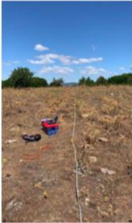
Stendimento M1 dal Geofono 1 al Geofono 24
