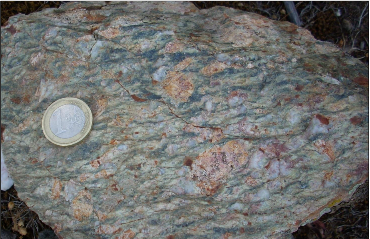
Figura 7. 1: Foliiazione pervasiva di piano assiale nei Porfiroidi
