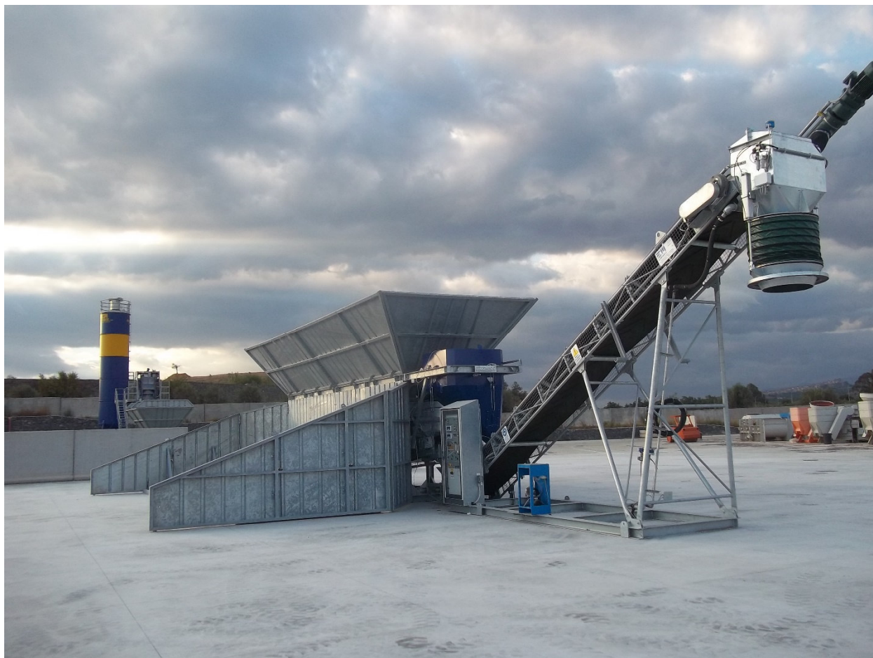
Figura 9 – Foto di un impianto di betonaggio semovente in esercizio
