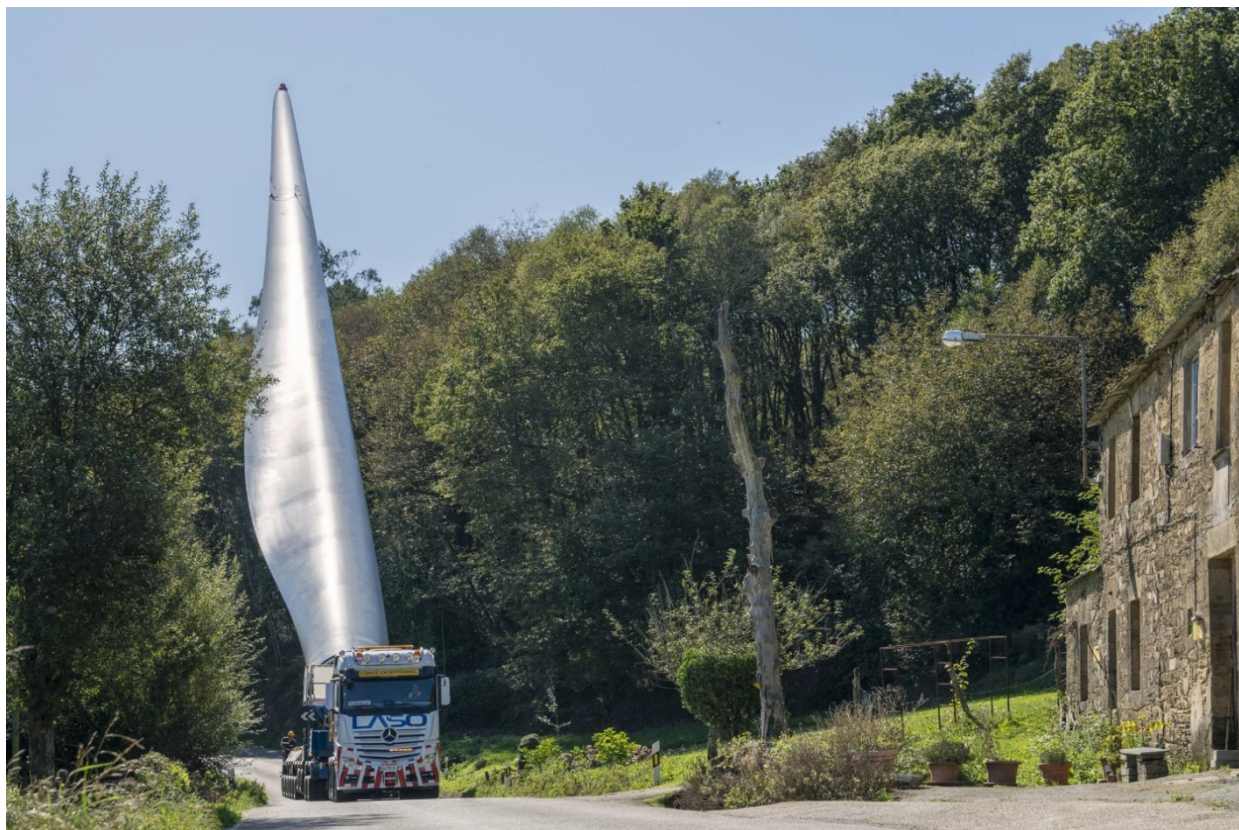
Figura 4 – Blade lifter, utilizzato per il trasporto di pale per aerogeneratori
