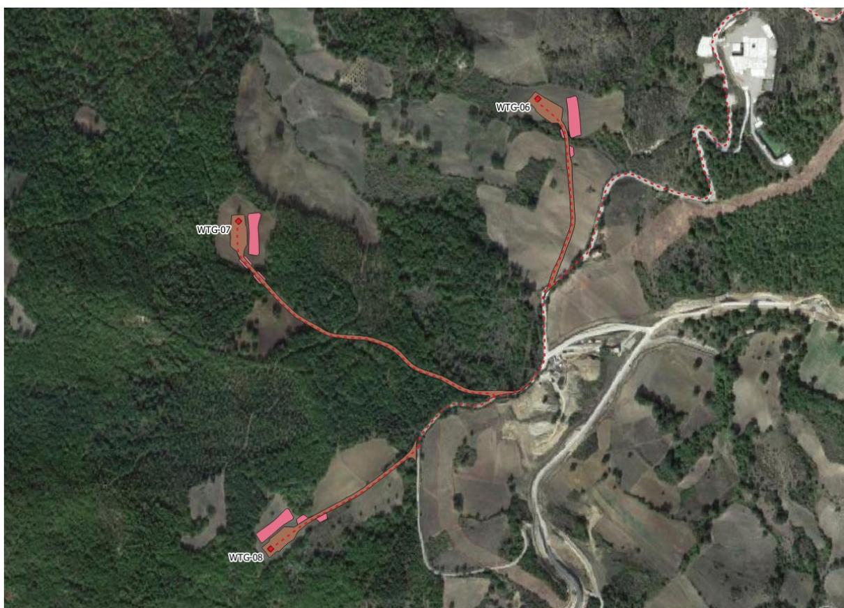
Figura 3 – Ubicazione degli aerogeneratori su terreni agricoli
