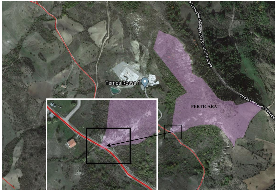
Fig.3 –Nel riquadro nero il dettaglio dell’interferenza del cavidotto(in rosso) con una minima porzione dell’area di vincolo (in lilla).
