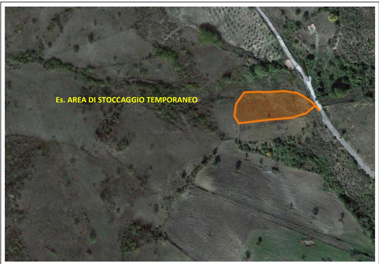
I terreni potranno essere adagiati direttamente sul suolo e dovranno essere dotati di sistema perimetrale di raccolta delle acque che consenta di convogliare le acque cadute sul piazzale verso un sistema di depurazione idoneo al trattamento primario delle acque, con scarico verso uno dei fossi presenti nella zona.
