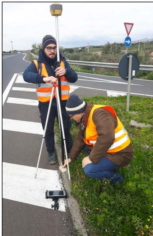
*Fig. 4 Operazioni di collaudo metrico del punto Pol 21*
